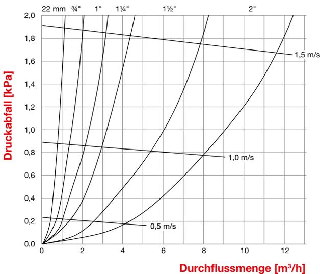
Dank der innovativen Konstruktion der Luft- und Schlammabscheider dieser Smart-Serie beschränkt sich der Druckverlust in der Anlage auf ein Minimum. Selbst bei Strömungsgeschwindigkeiten von 3 m/s erzielt die Smart Serie die besten Ergebnisse. Der hohe Wirkungsgrad garantiert die optimale Funktion der Heizungs- oder Kühlanlage. Mithilfe des nebenstehenden Diagramms läßt sich einfach die benötigte Größe ablesen.
