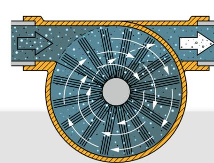
Konventioneller Abscheider mit komplettem Durchfluss: Geringe Abscheidung von maximal 25% pro Zyklus.
